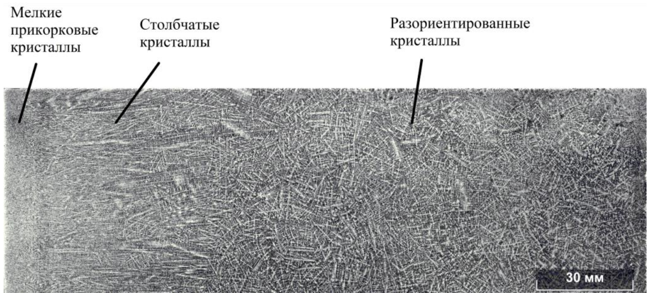
Рис.2.1. Фрагменты дендритной структуры исследуемых колесной (а) и рельсовой (б) НЛЗ
